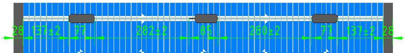
Abbildung 5. Position der Anschlussdose bei Modulen Blackstar B.108 and SOLID Framed B.120
